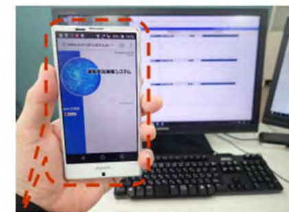
(検知した異常データは携帯端末で受信) 図3 端末装置と携帯端末の画面表示
